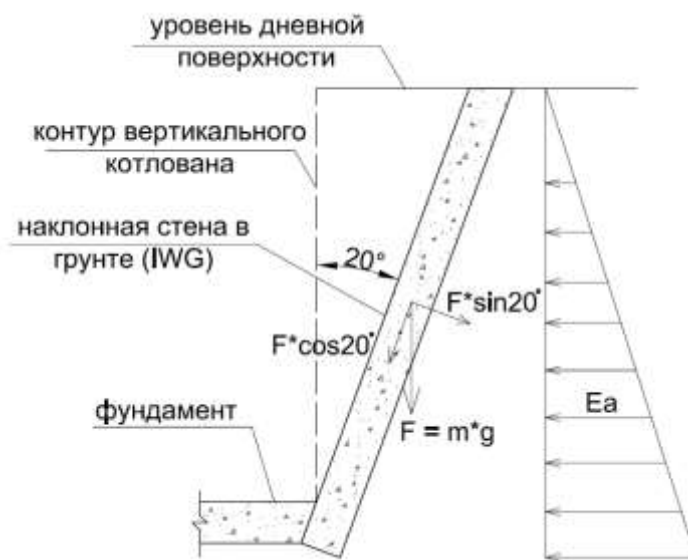
«Рис. 1» – Схема действия нагрузок от наклонной стены в грунте
