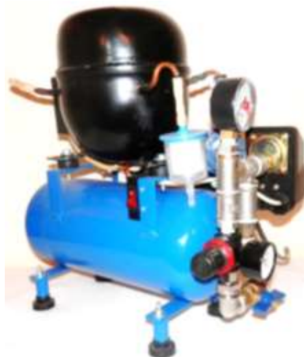
Рисунок 2 – Компрессор для аэрографа, сделанный своими руками
